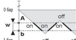
Когда уровень вакуума достигает нижнего значения «A» = -0,45 бар, цифровой выход включается и электрические настройки остаются в силе до тех пор пока обнаружено реле значение вакуума не снижается ниже верхнего предела 0,60 бар (то есть «b»).
