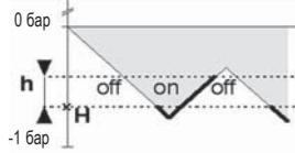
Если уровень вакуума достигает значения H цифровой выход включается; электрические настройки остаются в силе до тех пор пока обнаружено реле значение вакуума не снижается ниже значения -0,45 бар (следовательно, H-h=0,6-0,15= 0,45 бар). В данной точке выход отключает электрический сигнал.
