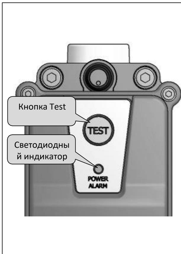
При нажатии на кнопку Test откроется клапан.
