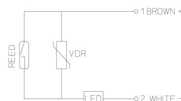
VIP-клапан може бути оснащений магнітними кінцевими вимикачами та сигналним світлодіодом. Кінцеві вимикачі поставляються з комплектом, який дозволяє легко і швидко виконувати їх монтаж ззовні. Тому необхідно зазначати кінцеві вимикачі при замовленні клапана.
