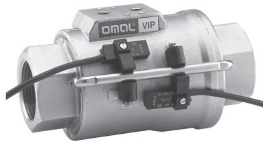
ДЛЯ ВІДСТЕЖЕННЯ ПОЛОЖЕННЯ КЛАПАНА В ЗАКРИТОМУ АБО ВІДКРИТОМУ ПОЛОЖЕННІ, МОЖЛИВЕ ВИКОНАННЯ КЛАПАНА З МАГНІТНИМ КІЛЬЦЕМ НА ПОРШНІ ТА ОДНИМ АБО ДВОМА ГЕРКОНОВИМИ ДАТЧИКАМИ
