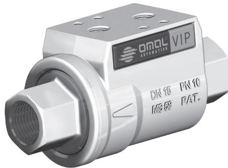
Відсічний клапан Серії VIP типу «відкритий-закритий» має запатентовану конструкцію (клапан і пневмопривод об'єднані в один корпус), малі габарити та вага, широкий спектр опцій і типорозмірів, мале споживання повітря, не повнотріхідний переріз. Існує можливість монтажу в будь-якому просторовому положенні. Відсутнія залежність від рівня вхідного та вихідного тиску. Можлива модифікація з герконовими датчиками.
