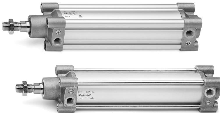
Пневматические цилиндры 63 серии были разработаны для обеспечения высокой производительности и гибкости эксплуатации. Благодаря новой системе регулируемого пневматического демпфирования в цилиндрах удалось достичь снижения шума от удара поршня о крышки.
