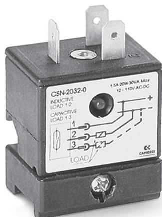
Магнитные датчики положения модели CSN 2032-0 состоят из геркона, дополненного схемой электронной защиты, светодиодной индикацией красного цвета и изолированным герметичным корпусом. Модель CSN 2032-0 оборудована специальной системой, позволяющей устанавливать датчик непосредственно на шпильку цилиндра.
